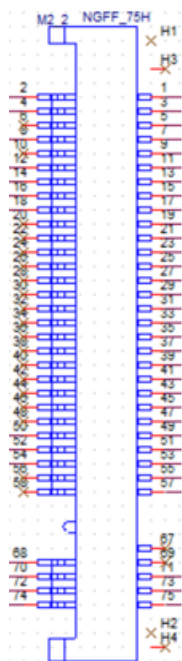
图 2-12 M.2 B-Key 示意图
